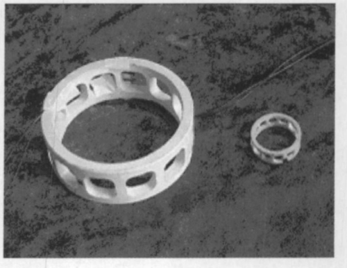
图 1 实物保持架和模型保持架 Fig. 1 Physical retainer and the model retainer
